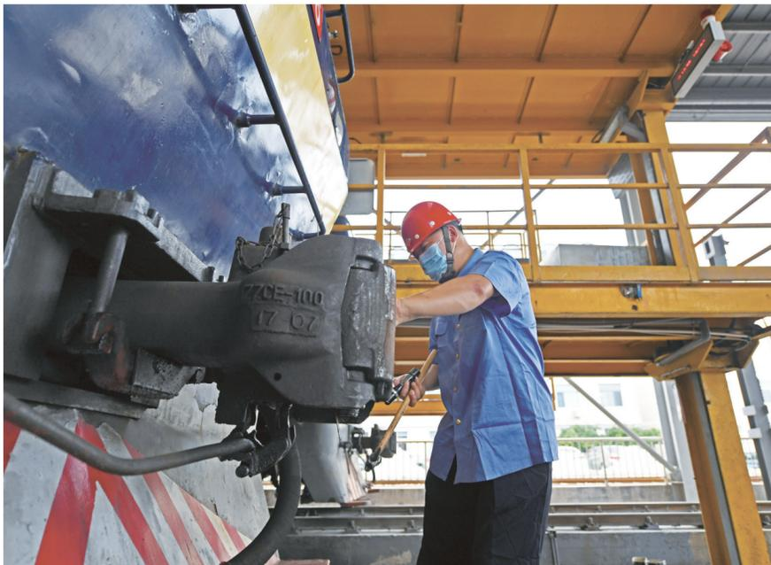
8月11日，在中国铁路北京局集团有限公司天津机务段检修车间，内燃机车检修工人对机车外部进行检查作业。连日来，中国铁路北京局集团有限公司天津机务段员工冒着高温，忙碌在机车检修岗位上。机车检修人员对整备场中机车的机械室、车顶、车底、车轮进行检查作业，以保障机车的安全运行。新华社记者 赵子硕 摄
